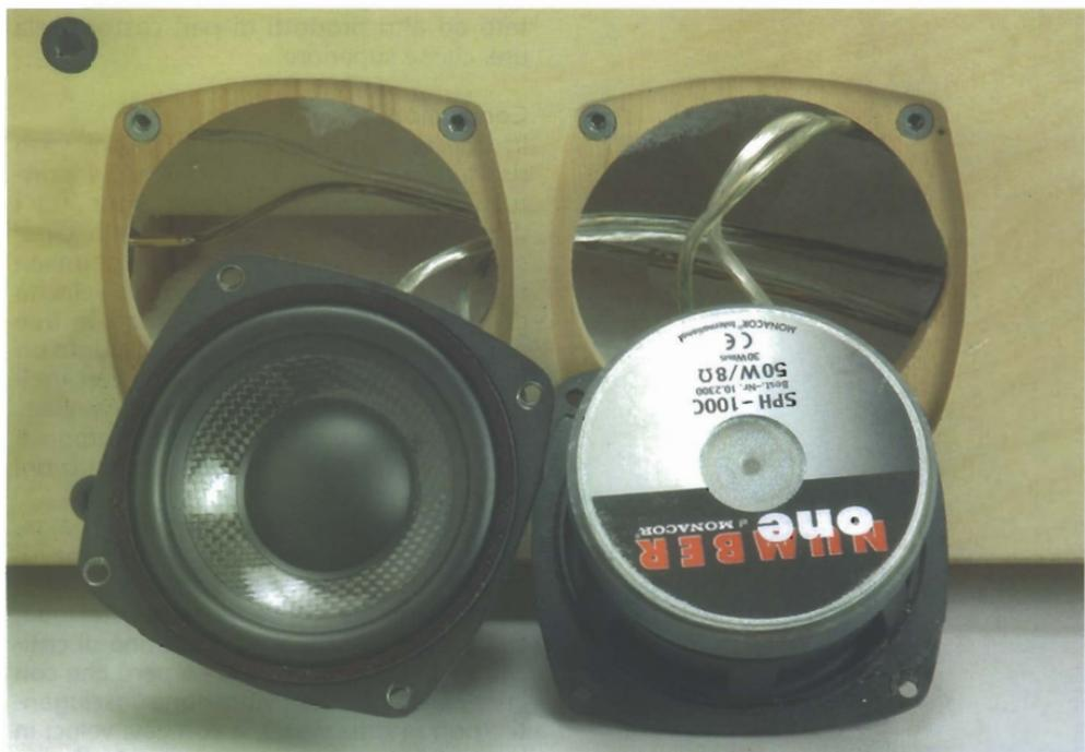
*I due piccoli mid-woofer da 11 cm sono dei Monacor della serie più pregiata; notare il sistema di montaggio impeccabile con viti e madreviti annegate nel legno del baffle opportunamente fresato.*
