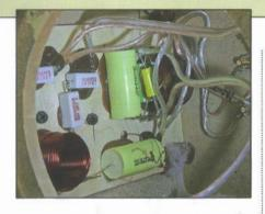
Sopra: i componenti sono incollati su una pregiata basetta di compensato di betulla. I collegamenti sfruttano principalmente i reofori dei componenti e il restante cablaggio è effettuatoin aria con i cavi degli altoparlanti. Ottimi i componenti leggermente disordinata la disposizione.
